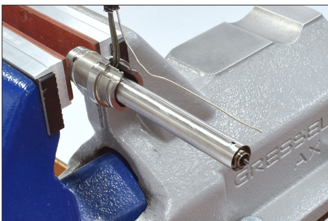
Abbildung 83: Defekten Thermofühler demontieren
