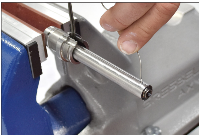
Abbildung 85: Thermofühler in die Bohrung der Düse stecken
