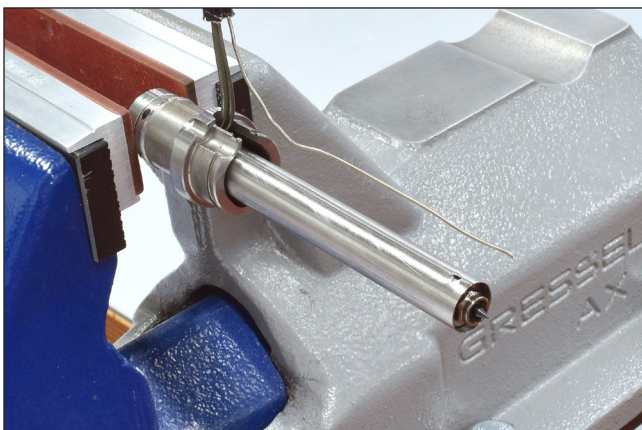
Abbildung 102: Defekten Thermofühler demontieren
