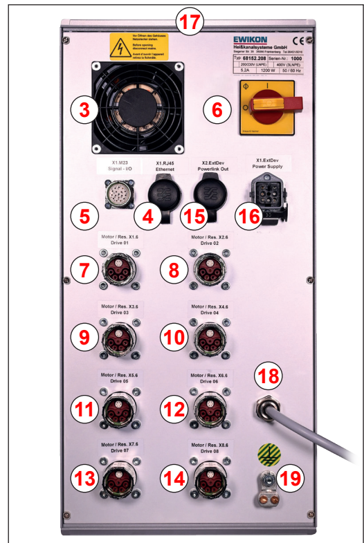
Abbildung 5: Anschlüsse an der Rückseite (Gehäuse für 8-fach Gerät)
